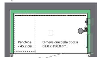
Generatore, Corpo a incasso e nicchia devono essere parzialmente incassati. Nella conversione, il generatore (profondità 12 cm) è montato sulla parete esistente, riducendo così lo spazio interno di 6 cm.
